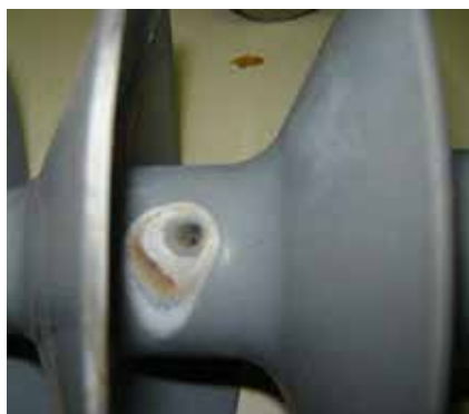
Figura 7 – Isolador polimérico para 138 kV que falhou em ensaio de frequência industrial devido a uma bolha interna
