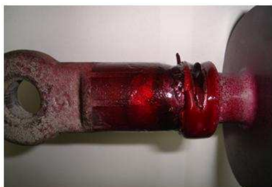
(a) Aspersão do líquido penetrante nas ferragens integrantes.
