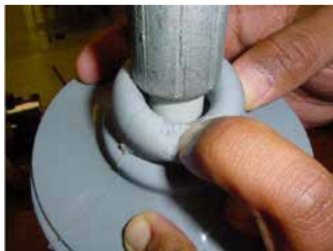
Figura 6 – Isolador polimérico para 230 kV com falta de aderência na região das ferragens integrantes
