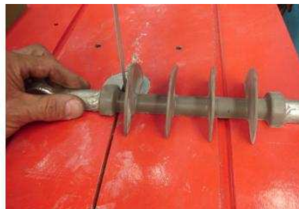
(d) Corte transversal para verificar a aderência da interface das ferragens integrantes
