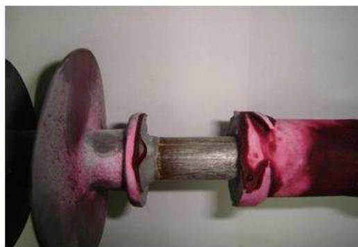
(b) Arrancamento da ferragem integrante durante o ensaio de tração mecânica, para visualização interna.
