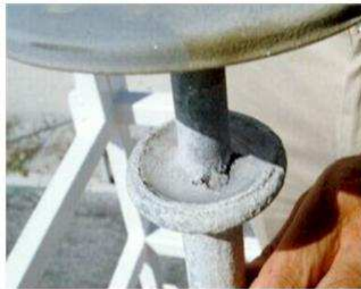
Figura 4 – Dano na selagem colocada na interface de um isolador polimérico
