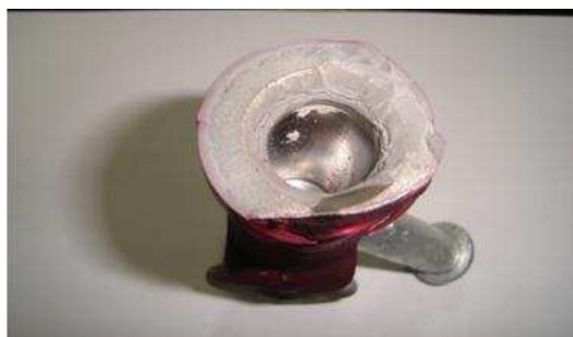
(c) Avaliação das partes internas das ferragens integrantes, após o arrancamento.
