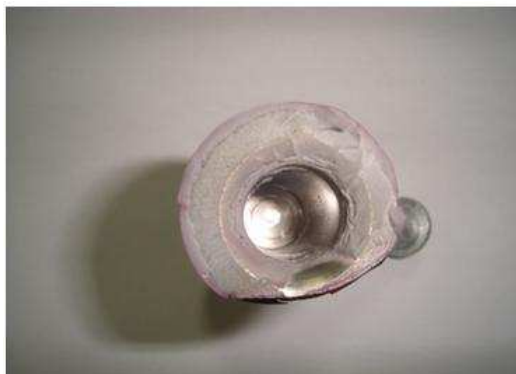
(c) Avaliação das partes internas das ferragens integrantes, após o arrancamento.
