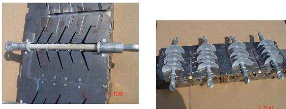
Figura 1 – Revestimento do núcleo por injeção à baixa pressão e vulcanização com alta temperatura (HTV)
