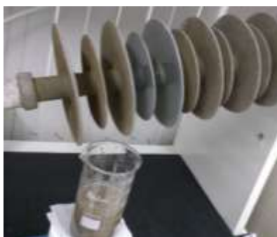
Fig. 7. Isolador após retirada dos poluentes
