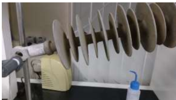
Fig. 5. Isolador no suporte para retirada dos poluentes
