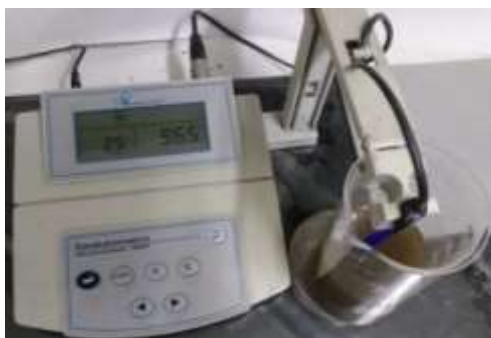
Fig. 10. Medição da condutividade com a solução de água contendo os poluentes
