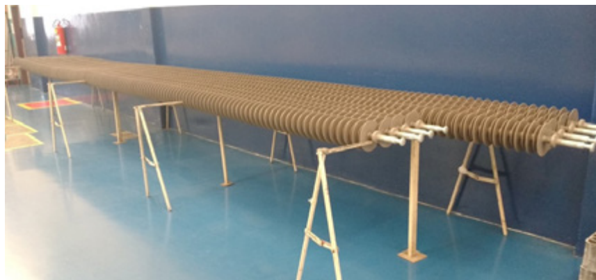
Figura A17.12: Protótipos dos isoladores para 1.000 kV CA durante a fabricação
