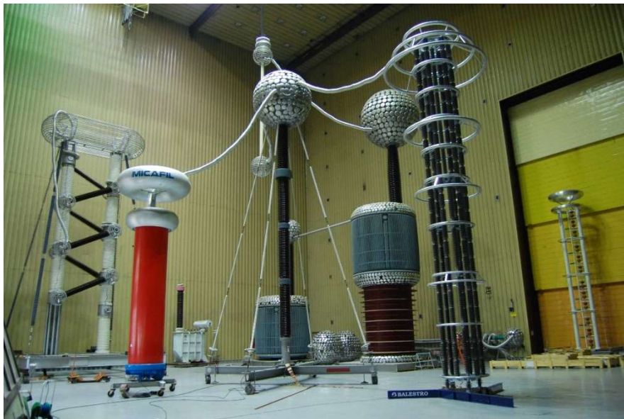
Arranjo para os ensaios do para-raios UAT em frequência industrial no CEPEL
